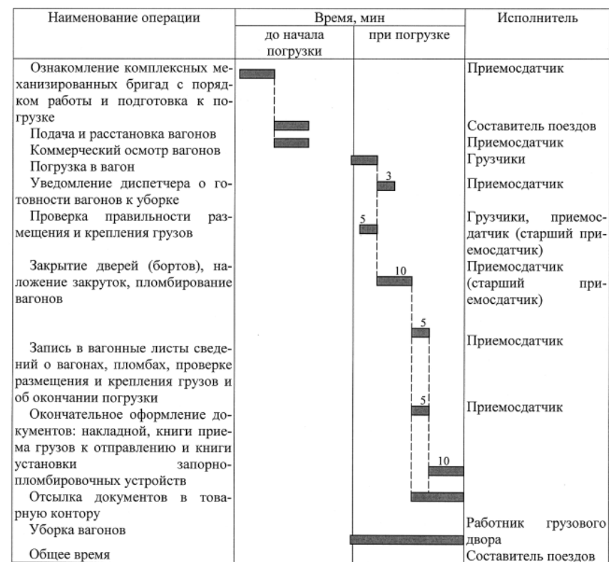
Рис. 2.3. Примерный график выполнения операций при погрузке грузов из склада станции в вагоны
