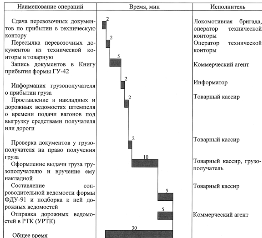
Рис. 1.2. График обработки документов в товарной конторе станции на прибывшие грузы при централизованных расчетах за перевозки
