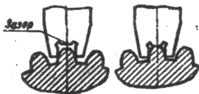
Р и с. 3. Схема замера зубчатого колеса с помощью пластинчатого шаблона
