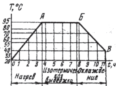
Рис. 11. Характеристика температурного режима в процессе автоматического регулирования
