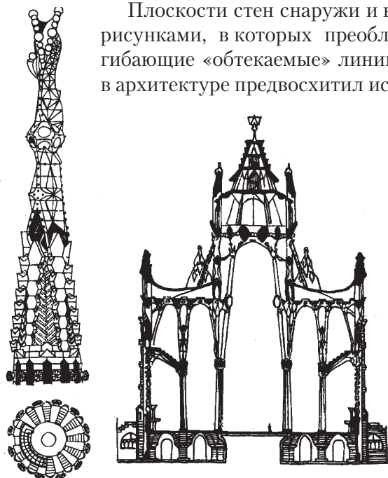
Рис.52. Конструктивная схема и деталь башни кафедрального собора Саграда Фамилия в Барселоне (арх. А. Гауди, 1882–1926 гг.)
