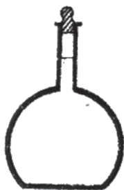
Рис. 4. Пикнометр: с притертой пробкой и с кольцевой риской на горлышке
