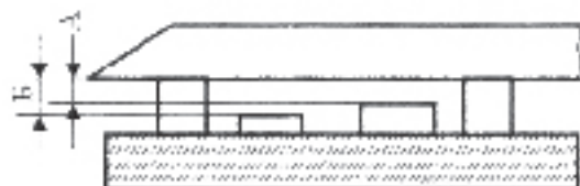
Рис. 8. Образец для определения значений просвета: 1 – шкальная линейка; 2 – плоскопараллельные концевые меры длины; 3 – плоская стеклянная пластина; А, Б – значения просвета
