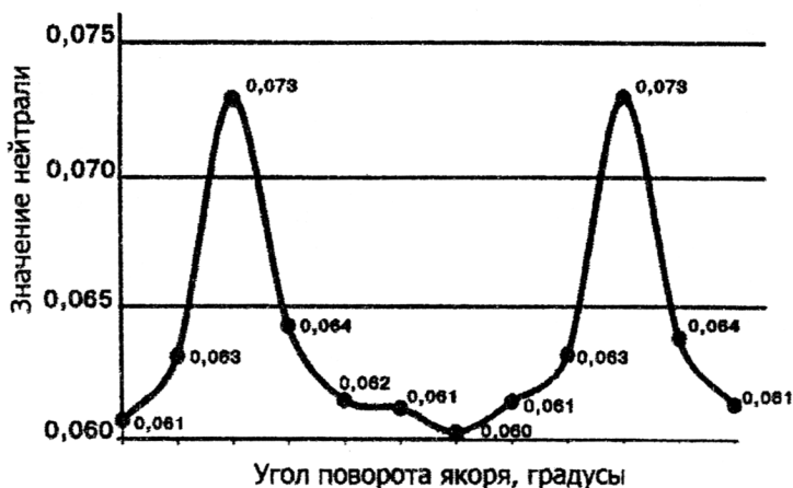
Рис. 8. График значений нейтрали тягового электродвигателя НБ-418К при повороте якоря на угол 60^\circ между двумя щетками
